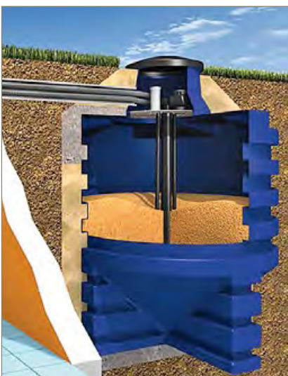
Abb. 17: Erdlager aus Kunststoff mit senkrechter Förderschnecke
